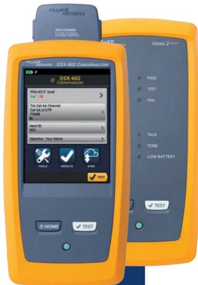
La certification comprend tous les tests qui sont effectués au cours d'une vérification et d'une qualification, plus des mesures prédéfinies par les normes établies par les organismes TIA ou ISO.
